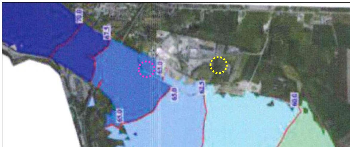
**Fig. 6-2 – Risultati del modello: massime quote idrometriche raggiunte nel corso della piena del 1966; individuazione area occupata dall'impianto di riciclaggio esistente (rosa) e quella futura (giallo)**
