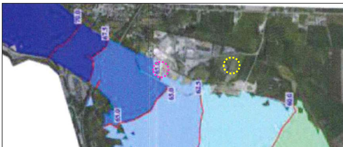
Fig. 3.1 – Risultati del modello: massime quote idrometriche raggiunte nel corso della piena del 1966; individuazione area occupata dall'impianto di recupero esistente (rosa) e quella futura (giallo)
