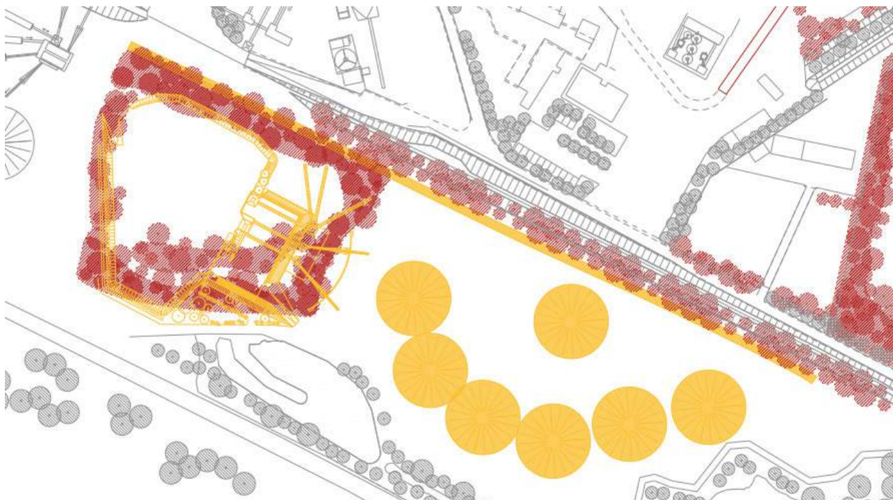
Figura 3-10: Tavola comparativa: in giallo l'impianto oggetto di spostamento e l'eliminazione del tratto di strada lungo l'argine avanzato, in rosso i nuovi impianti arborei ed arbustivi
