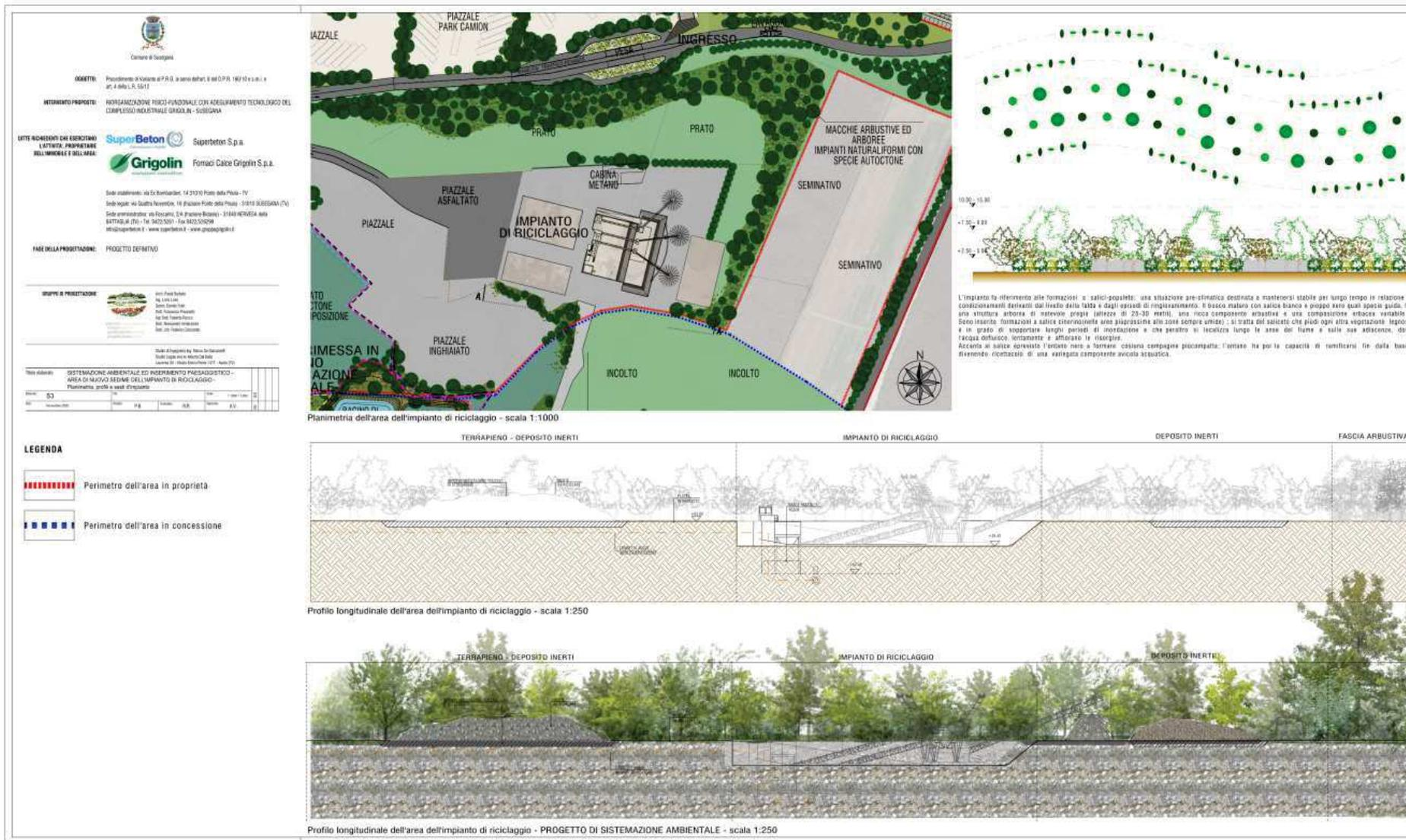
Figura 3-13: Sistemazione ambientale area demaniale – Area di nuovo sedime nell’impianto di riciclaggio – Planimetria, profili e sest d’impianto
