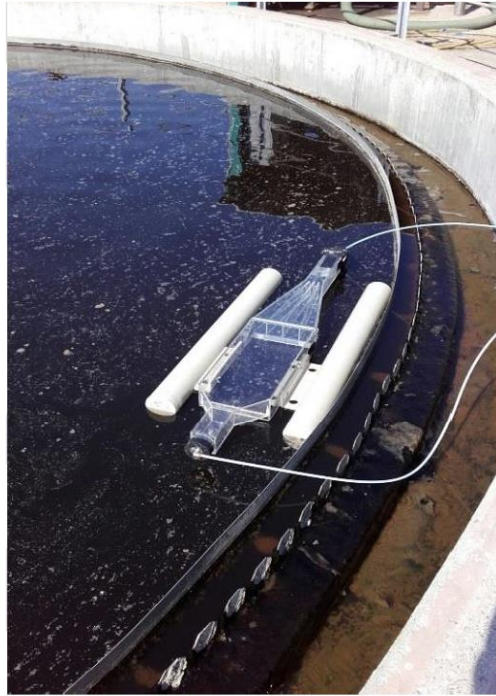
Figura 14: cappa di campionamento "wind tunnel".
