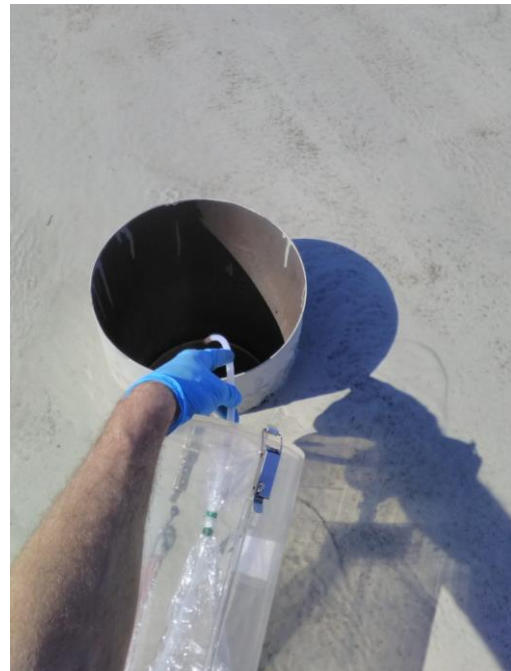
Figura 5: prelievo all'uscita dello scrubber a soda
