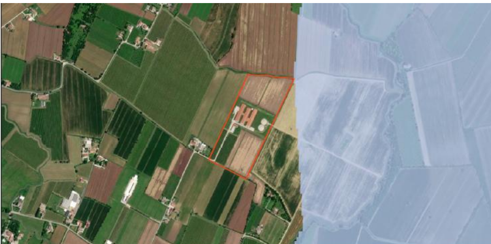
Figura 12: Estratto cartografia di Piano con indicato il tirante idraulico in caso di alluvione per TR 300 anni
