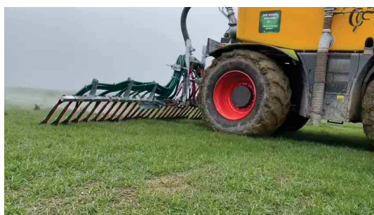
Distribuzione a rasoterra in bande con deflettore
