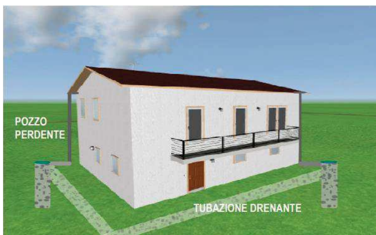
Figura 4 Schema di impianto dei pozzi perdenti per edificio singolo (fonte: VCI del PAT Comune di Maser)
