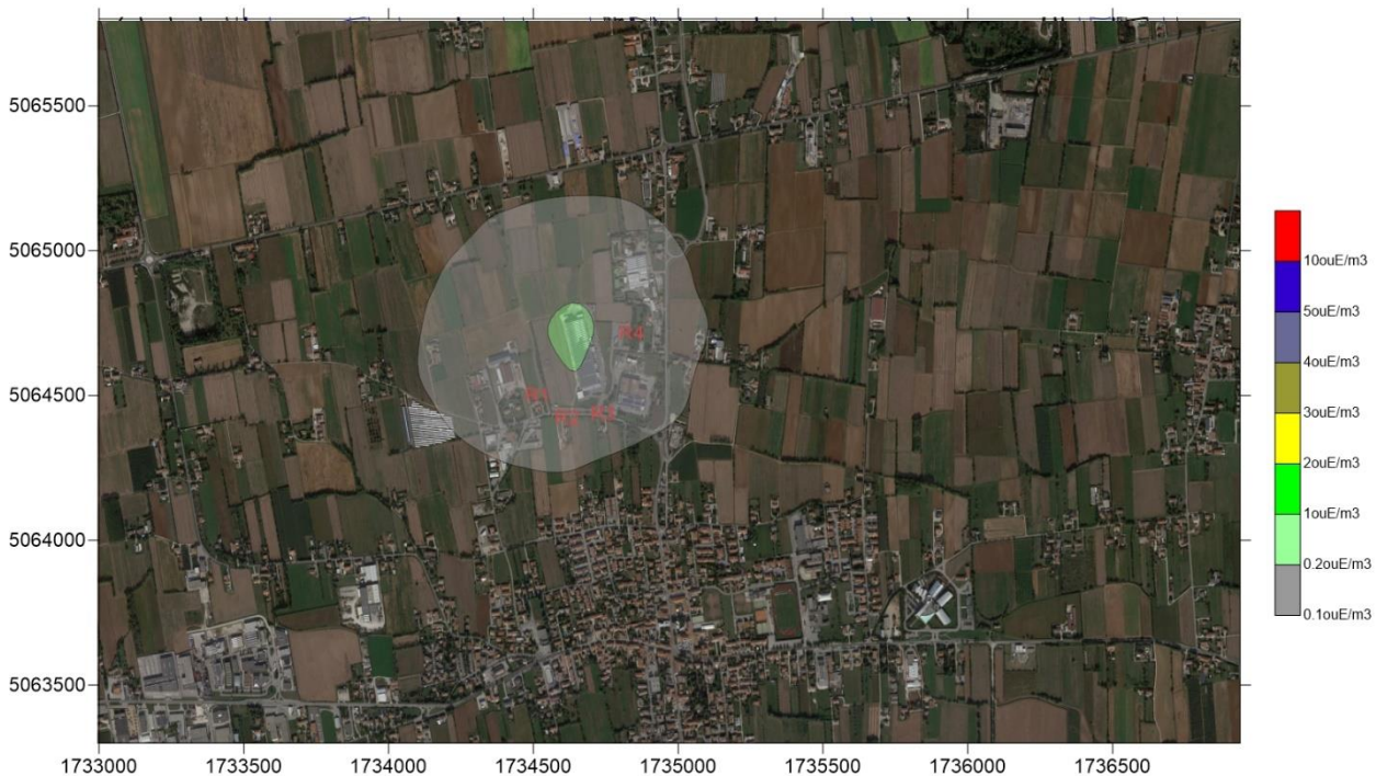
Figura 4- Risultati della modellizzazione diffusionale dello scenario progettuale. 98esimo percentile delle concentrazioni orarie.
