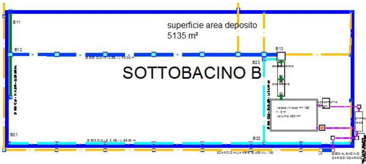
Figura 07 - Lo schema della rete di deflusso del sottobacino B nella configurazione di progetto
