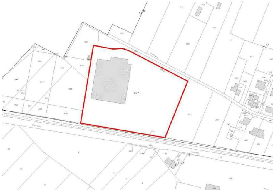
Il progetto consiste nella costruzione di un fabbricato industriale di superficie pari a 4.546,28 m<sup>2</sup>, inferiore a quella massima realizzabile di 13.018,80 (60% di 21.698,00 m<sup>2</sup>). Il fabbricato è realizzato con copertura a shed, su cui è installato un nuovo impianto fotovoltaico avente potenza complessiva pari a 96 kWp (nel rispetto del Dlgs 28/2011).
