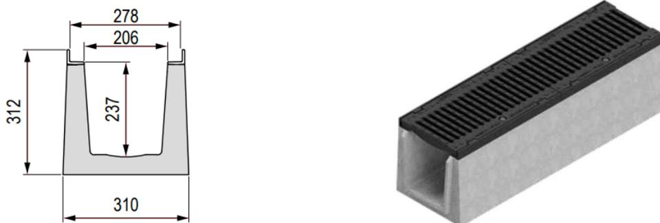
Figura 11: Schematizzazione di canaletta grigliata (tipo Gridiron)
