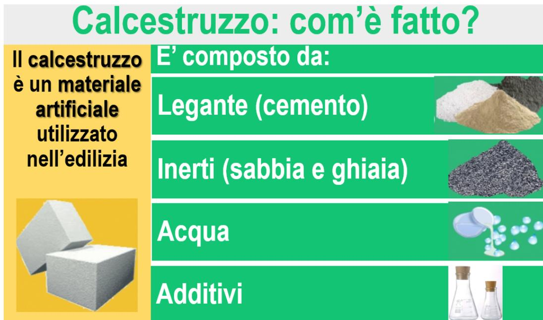
Figura 7: Esempio di composizione di un calcestruzzo: gli elementi costitutivi sono cemento, sabbia, ghiaia e acqua in diverse proporzioni in funzione delle caratteristiche del prodotto finale
