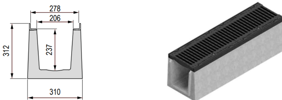
Figura 7: Schematizzazione di canaletta grigliata (tipo Gridiron)
