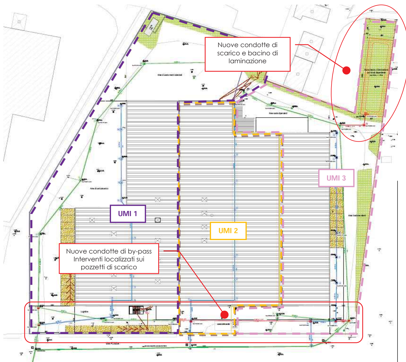
Fig. 11 - Progetto rete meteoriche.
