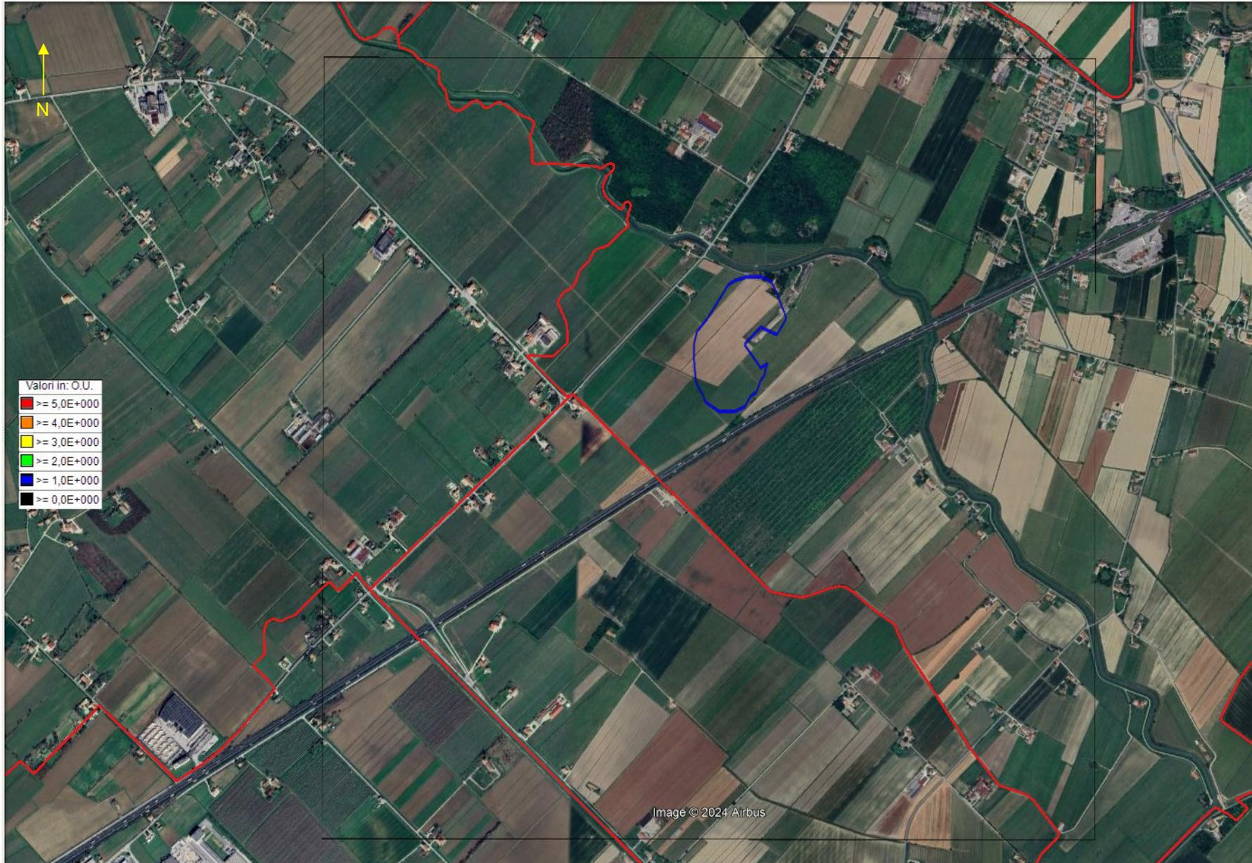
Mappa della dispersione del 98° percentile della concentrazione di picco ( $\text{ou}_E/\text{m}^3$ ) – Scenario 1 (SDP) – Dettaglio area impattata
