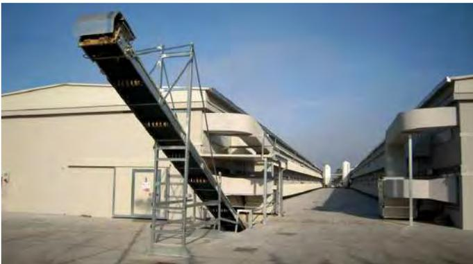
La raccolta delle deiezioni avviene per mezzo di un nastro rimozione pollina che le convoglia automaticamente verso il nastro trasportatore che le caricherà sul mezzo preposto al solo trasporto deiezioni, senza necessità di interruzione del ciclo produttivo.
