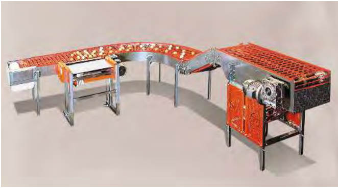
Sistema di trasporto delle uova tipo "anaconda"
