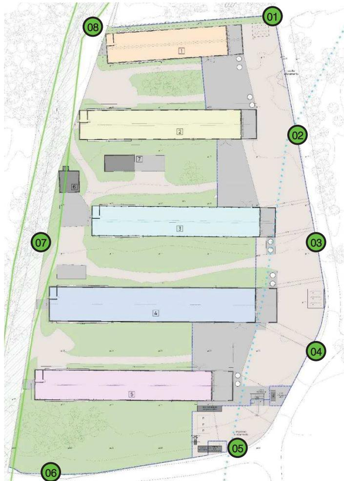
Fig.10 – Individuazione dei punti considerati per il calcolo dell'emissione sonora assoluta.
