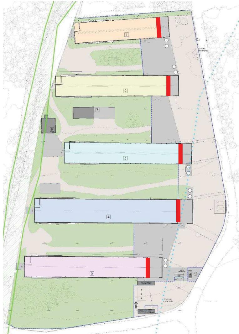
Fig.07 - Planimetria dell'allevamento nella configurazione di progetto con individuazione del lato ventilatori.
