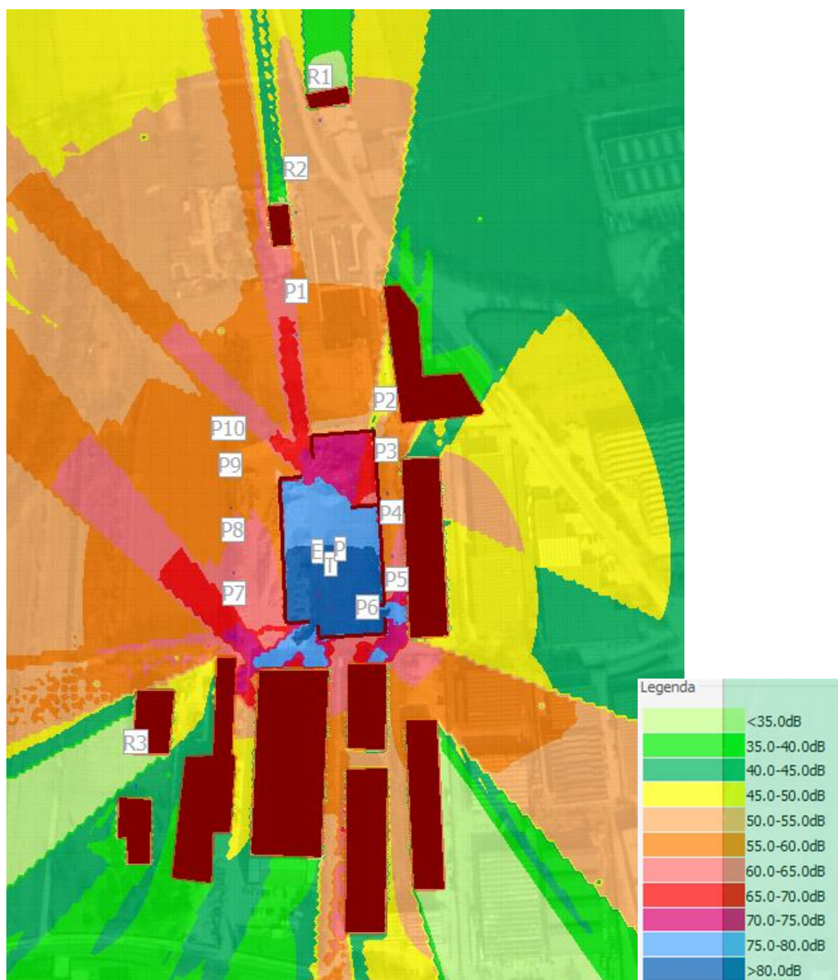
Isofoniche relative alla seconda situazione: trituratore escavatore, pala gommata in funzione.
