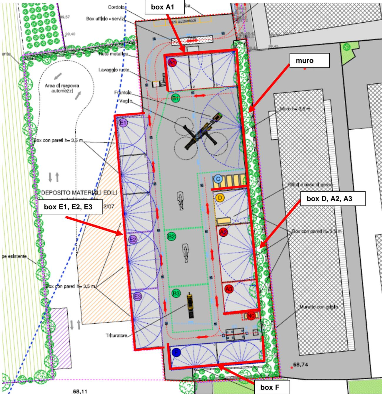
**Planimetria dell'impianto con indicati i box ed il muro equiparati a barriere acustiche.**
