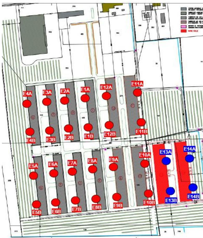
Figura 24. Planimetria con indicazione della posizione delle sorgenti odorogene nello scenario esistente (stato di fatto – SDF – in rosso) e nello scenario di progetto (stato di progetto – SDP – in blu).
