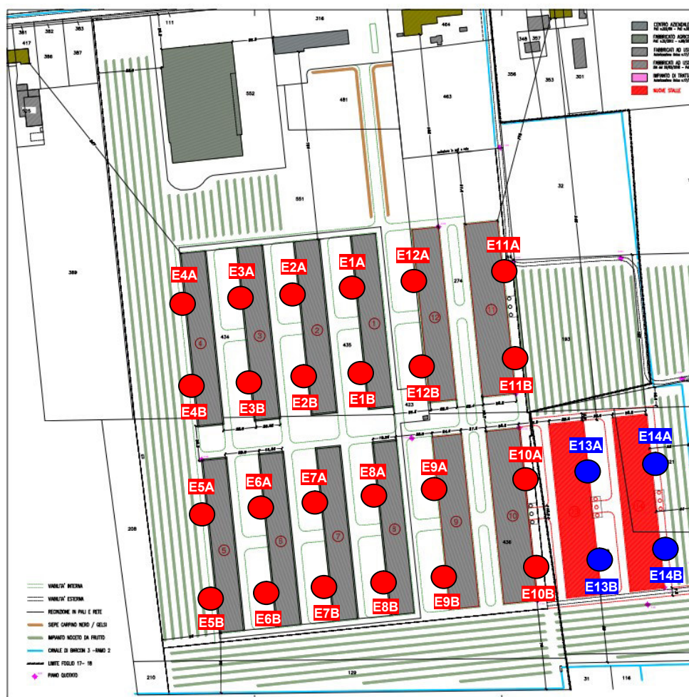
Figura 16: Planimetria con indicazione della posizione delle sorgenti odorigene nello scenario SDP. In rosso le sorgenti esistenti, in blu le sorgenti nuove.
