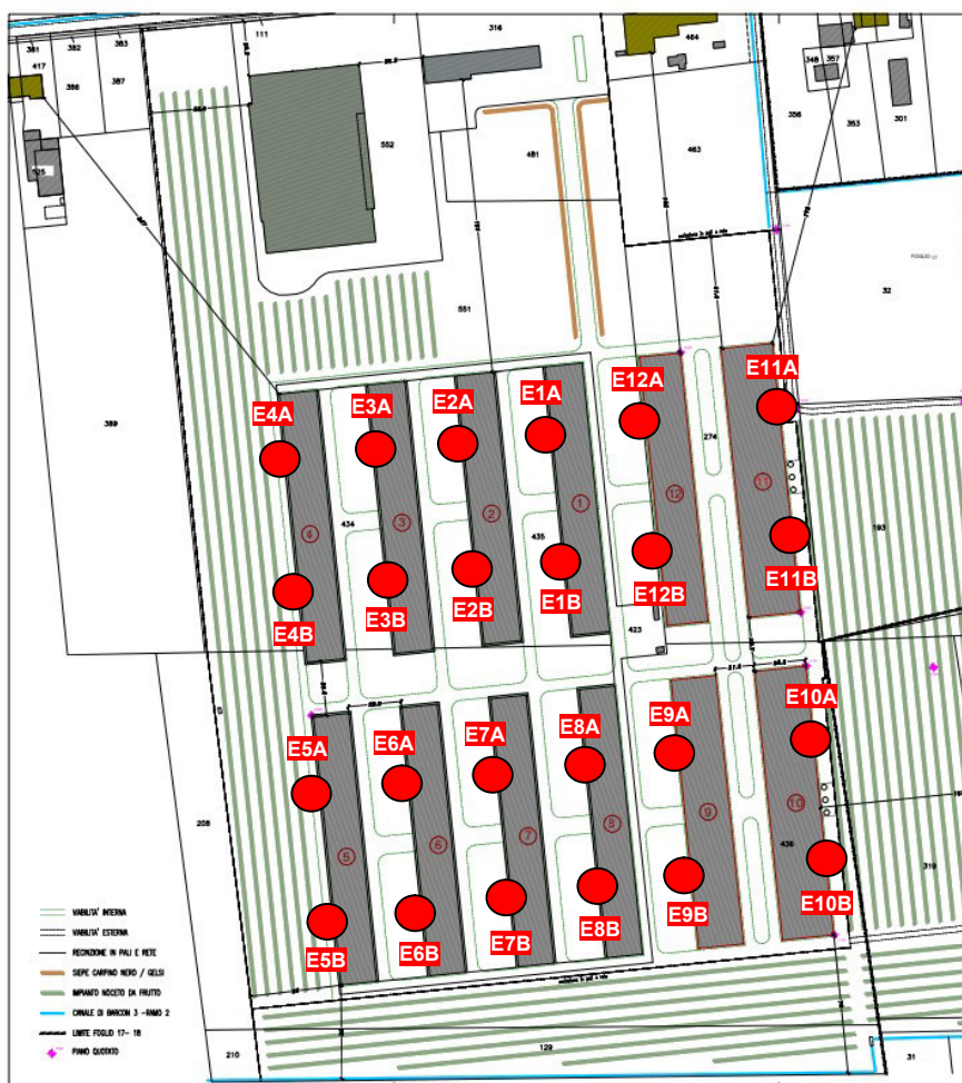
Figura 15: Planimetria con indicazione della posizione delle sorgenti odorigene nello scenario SDF.
