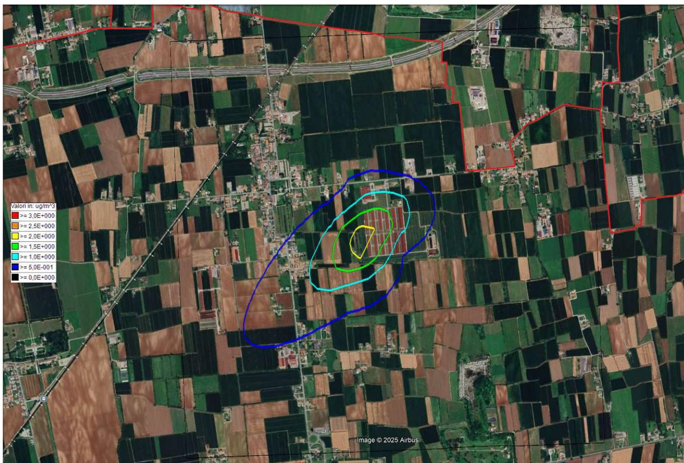
**Figura 20:** Mappa dei valori della concentrazione media annua di ammoniaca in  $\mu\text{g}/\text{m}^3$  nell'areale di studio nello scenario Stato di Fatto (SDF).
