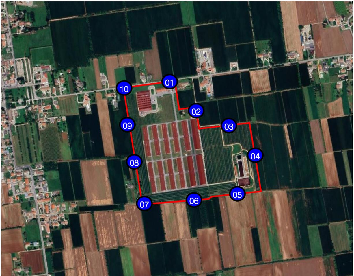
Fig.07 – Individuazione dei punti considerati per il calcolo dell'emissione sonora assoluta.
