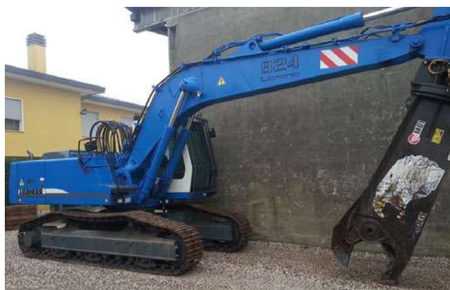
Immagine esemplificativa dell'escavatore e della pinza-cesoia
