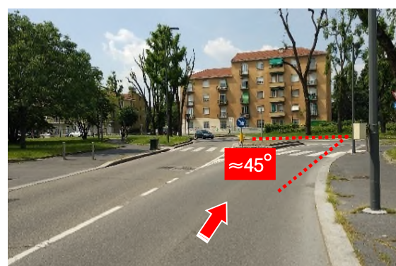
Figura 4.2 – Angolo di installazione dei radar rispetto alla direzione di marcia
