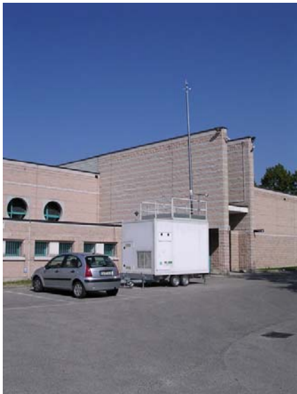
Figura 9 – stazione rilocabile per il monitoraggio della qualità dell’aria
