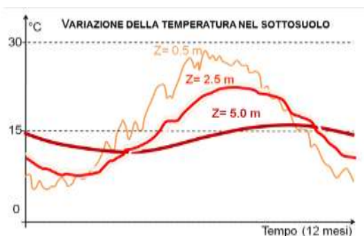
Figura 2 Andamento della temperatura in funzione della profondità nelle diverse stagioni dell'anno.
