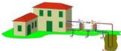
Figura 6 Schema di principio di una pompa di calore in regime di raffreddamento (De Carli, 2007).
