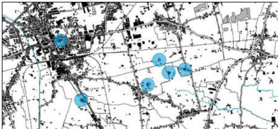
Figura 30 Esempio di identificazione delle zone di rispetto di raggio pari a 200 m nell'ntorno dei punti di captazione situati nel comune di Castelfranco Veneto (scala 1:25 000).
